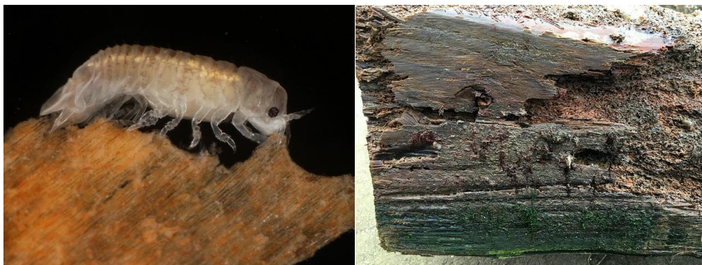
Figura 12. Limnoria en fase adulta y aspecto final de la madera atacada
