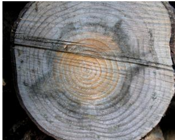
Figura 1. Coloración azulada de la madera a causa de los hongos cromógenos.
