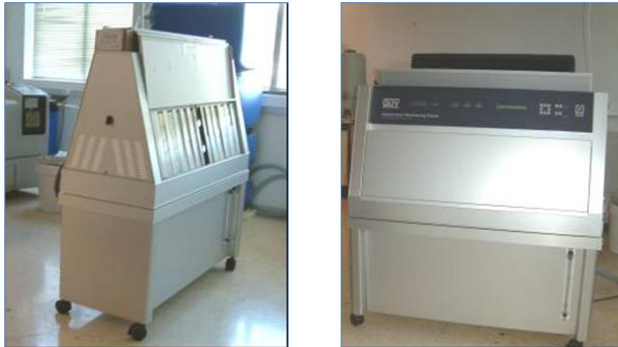
Figura 50. Equipo de envejecimiento artificial con lámparas UV, QUV.
