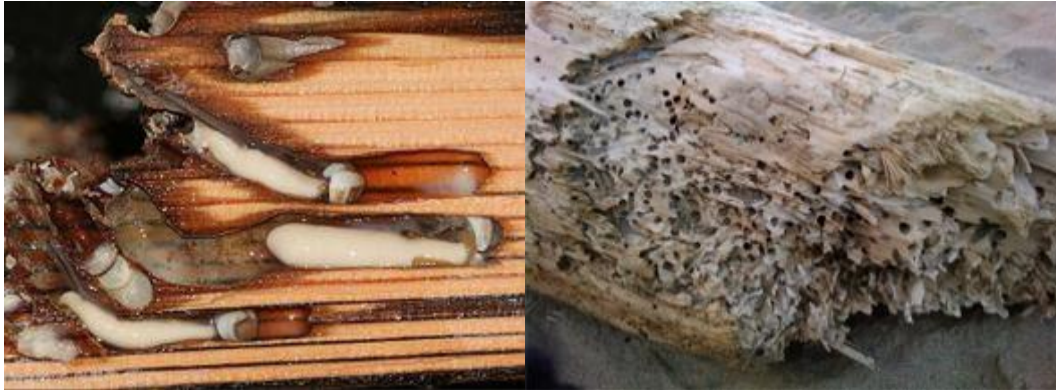
Figura 2. Gusanos de Teredo perforando una sección de madera y aspecto final de la misma tras ataque prolongado
