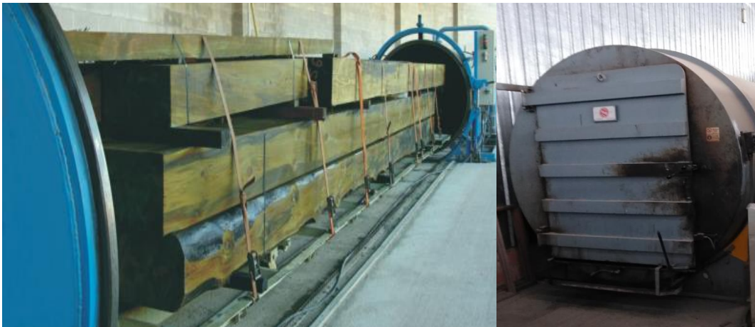
Figura 20. Disposición del autoclave en etapas de su uso. Carga de la madera
